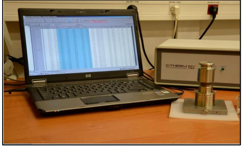
شكل (1) جهاز ((Mathis TC i) المستخدم لحساب التوصيلية الحرارية.
