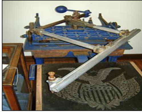
الشكل (3). آلة رسم الخرائط تقوم بعملية النحت أو الخرط
