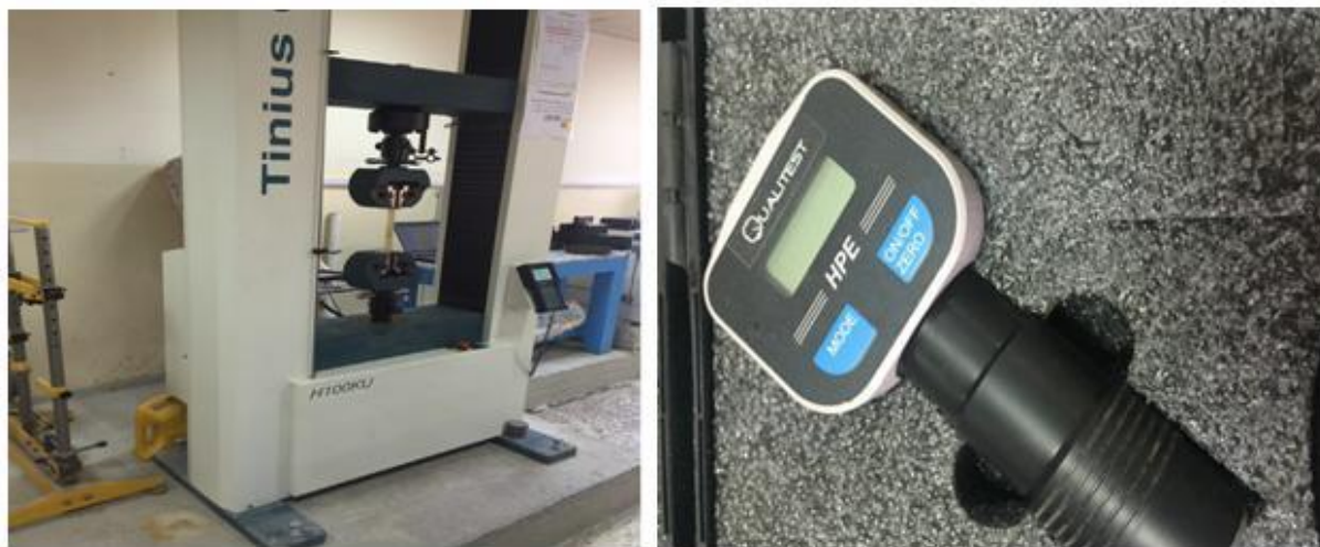
Fig.(2) (left universal tensile test, right) shore hardness (D)
