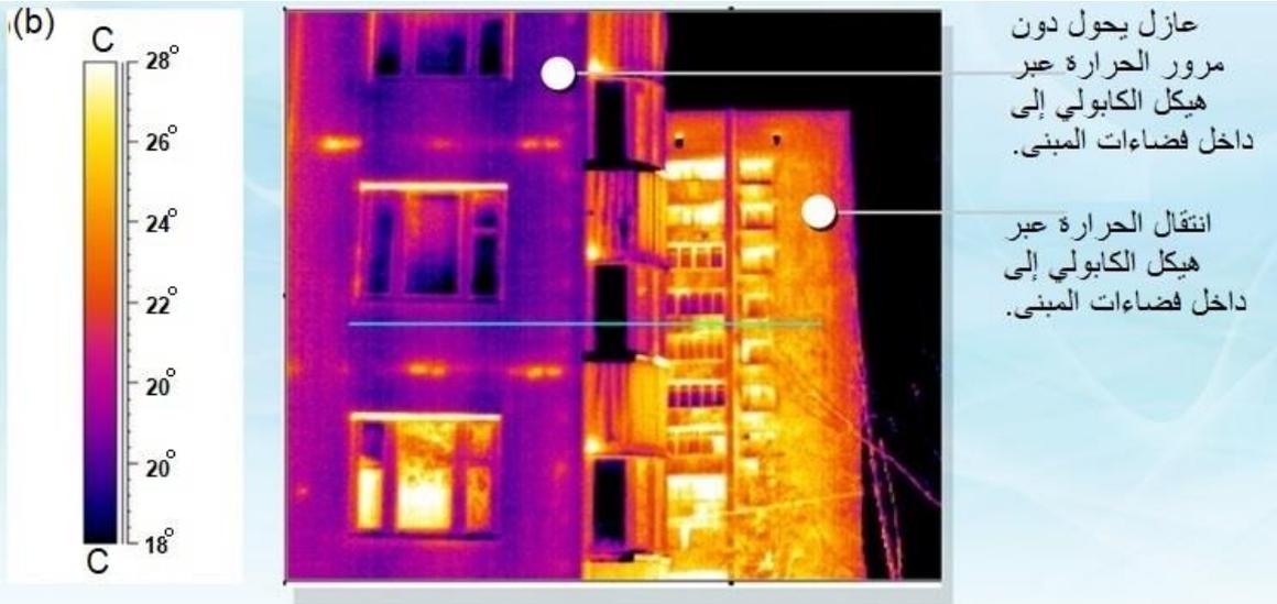
(الشكل-8) التصوير الحراري يوضح: (a) خلل إنشائي في منطقة الحمام عناصر إنشائية لمبنى سكني مما أدى لفقدان الحرارة: (b) انتقال الحرارة عبر عناصر الكابولي الخارجية إلى المبنى بطريقة الجسور الحرارية.
