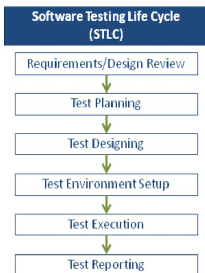
الشكل رقم (2) مراحل اختبار البرمجيات
