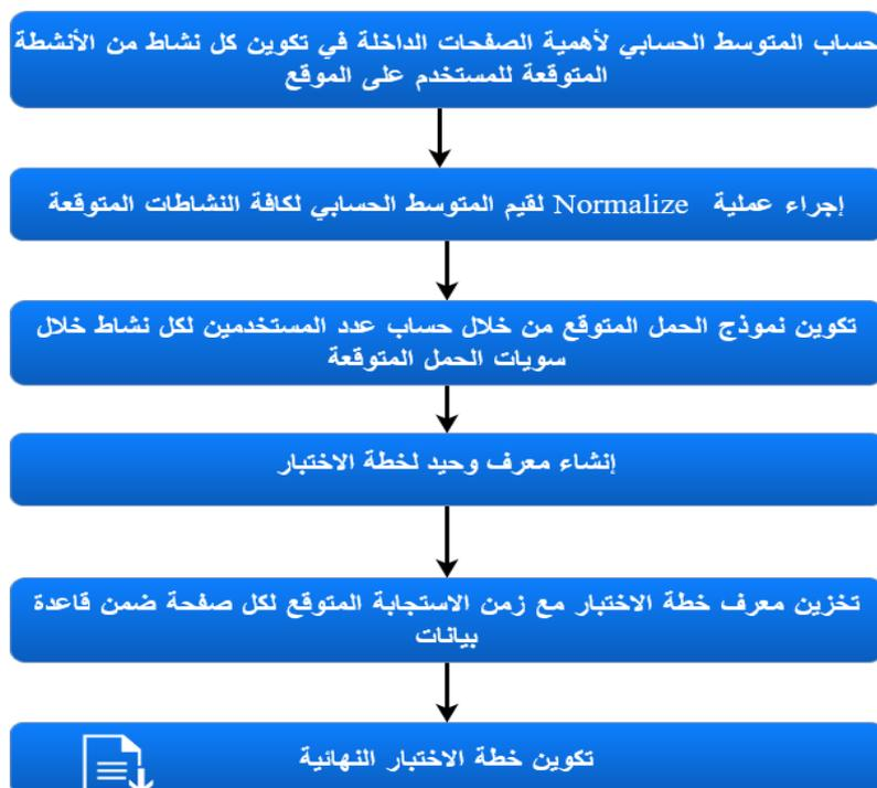
الشكل رقم (8) خطوات بناء خطة الاختبار
