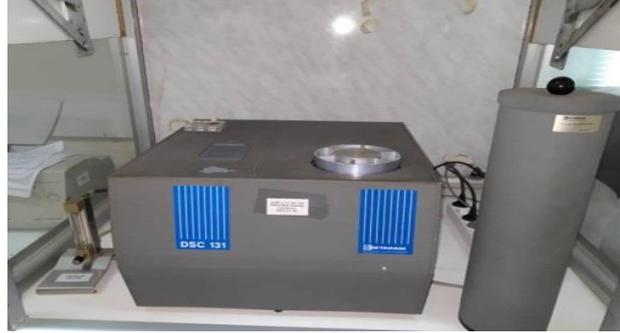
الشكل (3): يوضح جهاز اختبار (DSC131) في هيئة الطاقة الذرية بدمشق.
