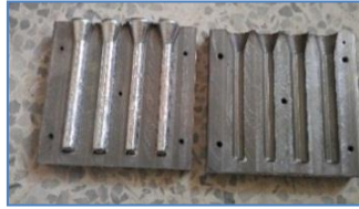
الشكل (11) القالب والعينات بعد الصب
