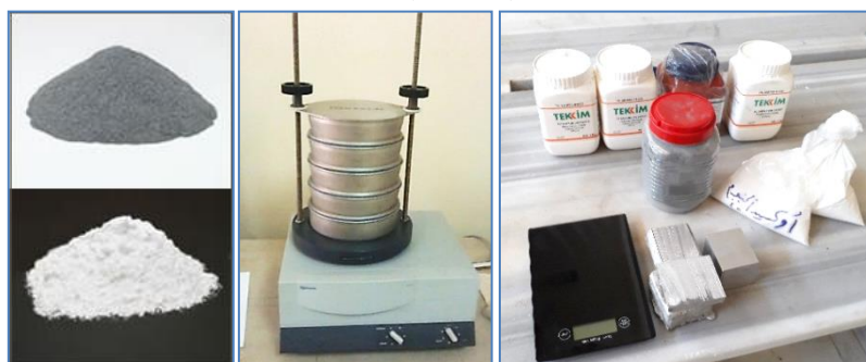
الشكل (6) جهاز المناخل المستخدمة والدقائق الدعمة بعد نخلها
