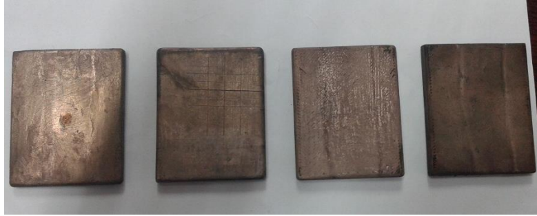
الشكل (6) يوضح بعض العينات بعد التلبس بالنحاس
