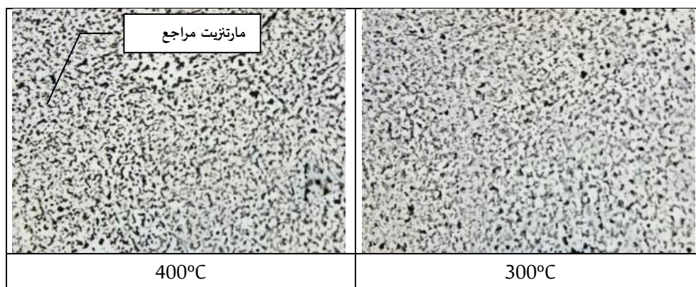
الشكل (5) البنى المجهرية للعينات المسقاة بالزيت والمراجعة عند درجات حرارة مختلفة
