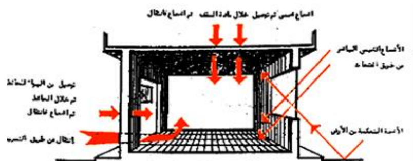
شكل رقم (2) الانتقال الحراري بين البيئة الخارجية والوسط الداخلي [15].
