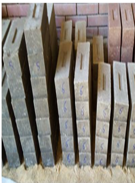
شكل رقم (4) رص وحدات البناء
