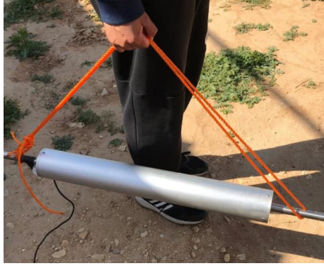
شكل (3). جهاز الكاشف المحمول The Mole المستخدم في القياسات.
